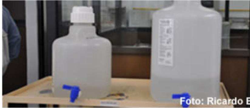
Cuando se eliminan las sales disueltas en el agua, aplicando un proceso de separación como la destilación o la ósmosis inversa (proceso de membrana), se pierde el equilibrio entre los aniones y cationes, y por lo general el agua se torna ácida por la prevalencia del dióxido de carbono ( $\text{CO}_2$ ); al eliminarle los iones como calcio y magnesio, se reduce la dureza del agua. El agua destilada carece de dureza y alcalinidad, y resulta muy agresiva.
